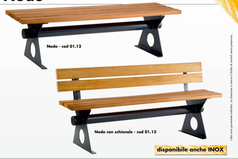
Struttura realizzata con due supporti laterali in lamiera spessore 4 mm tagliati con tecnologia "plasma" o laser e presso-piegati a freddo e collegati tra loro da N° 1 tubo diam. 100 mm, spessore 3 mm.
