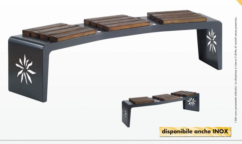
Struttura realizzata in lamiera spessore 3 mm tagliata con tecnologia "plasma" o laser e presso-piegata a freddo.
