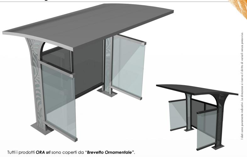
La struttura portante consiste in  $N^{\circ}2$  fianchi in lamiera zincata, realizzata tramite tecnologia al plasma, con possibilità di personalizzazione del motivo e da tubolari elettrosaldati a sezione quadrata mm 60 x 60, sagomati con raggio di curvatura adeguato.
